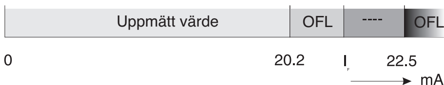
Fig. 4-2 Campo di misura 0... 20 mA, Errore rilevato >= Soglia errore ( I_F ), I_F = 20,5 mA
